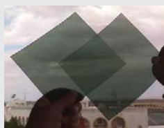
Fig. 4a: Se os filtros possuem a mesma orientação, a luz passa através deles.
