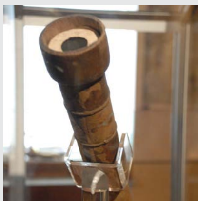
Fig. 7a: Um dos dois telescópios restantes de Galileu chegou ao Instituto Franklin na Filadélfia em 2009, na sua primeira visita aos Estados Unidos. É de notar que a parte externa da lente está coberta com um anel de papelão. Ao ocultar a parte exterior da lente, que é a parte menos precisa, Galileu melhorou a qualidade das suas imagens (Foto: Jay M. Pasachoff).
