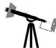
Fig. 10a: Observação solar por projeção com um telescópio (nunca olhe diretamente o Sol).
