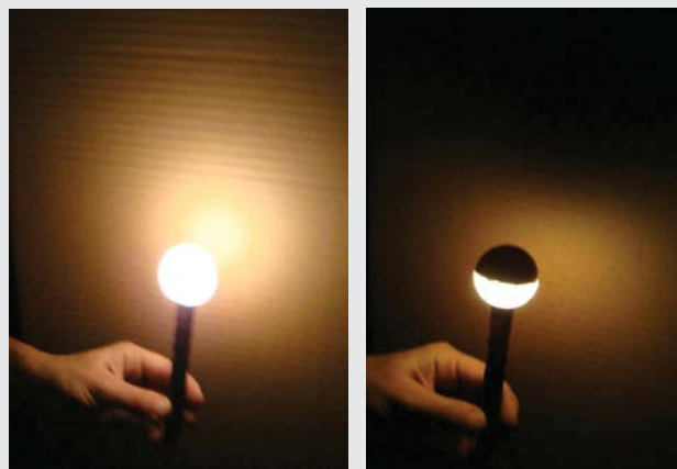
Fig. 16a: Lanterna sem proteção. Fig. 11b: Lanterna com proteção.
